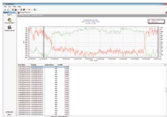
计量表报告：电耗（有效功率）和相应的功率因数（有效功率）以15分钟的间隔进行报告。在周末的时候只有少量的机器在生产，结果有效功率就减少了而功率因数会提高。图表显示出功率因数一直保持在0.9以上，说明了这是一个可接受的情况。这个图表也可以用来评估冷凝器的功能，从而提升功率因数。
